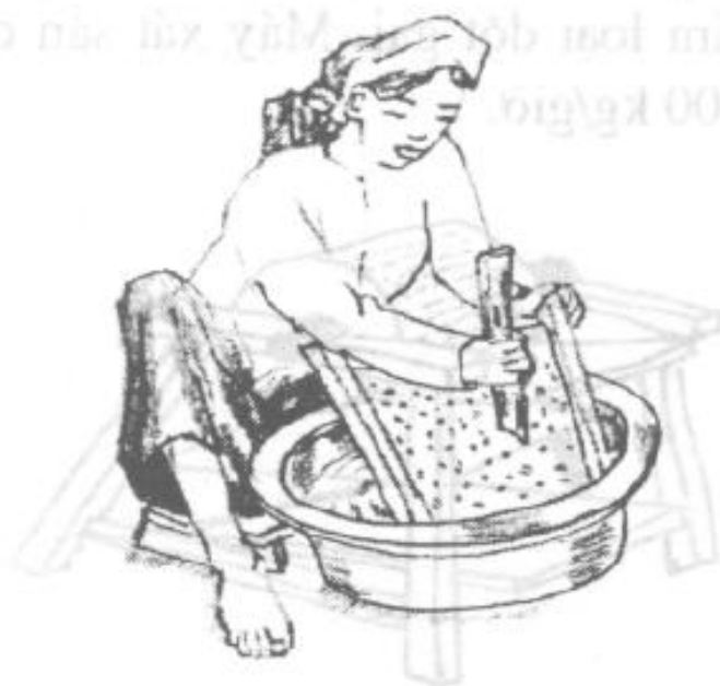
Hình 20. Bàn mài xát sản thủ công
